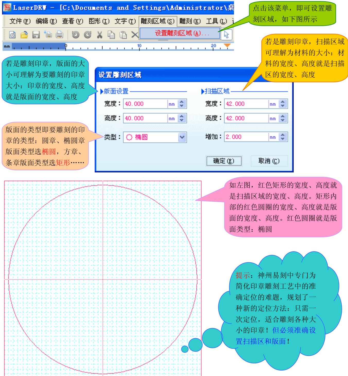
2、直接把扫描区映射到雕刻机的绘图仪上（可理解为直接把扫描区完整搬到雕刻机的绘图仪上）
