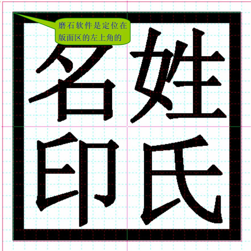
如果基于版面定位，那么每次雕刻前，雕刻机都要反窜到扫描区去！既然如此，就可以在定位好之后，预先减去每次都要反窜的距离，这样雕刻机就不用每次都反窜了！具体操作方法如下：按照常规激光打点法定好位，把水平定位、垂直定位减去要反窜的距离（默认是 1mm）即可。
