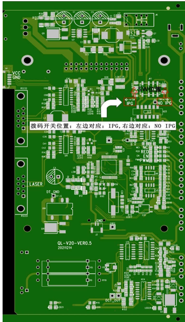
图 2.13 拨码开关示意图
