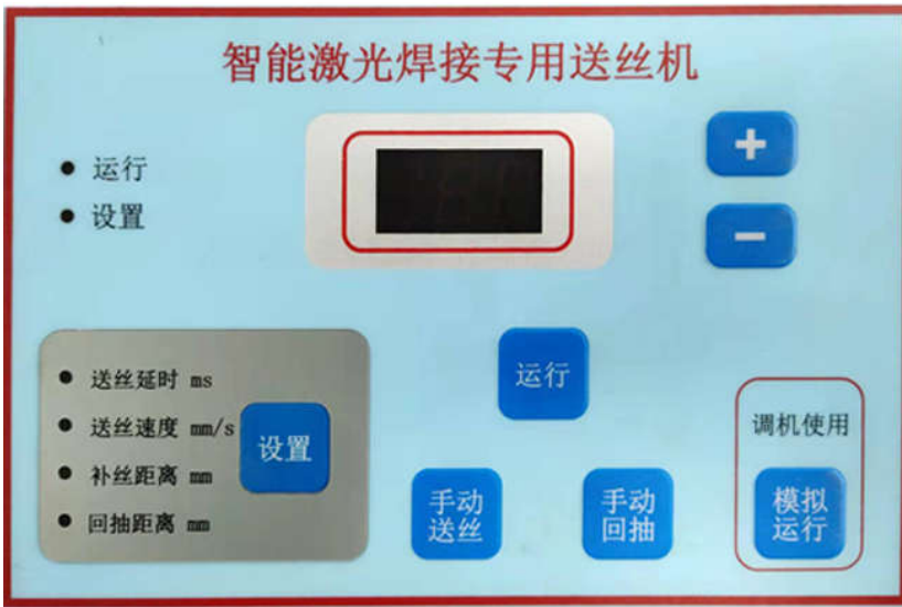
图 2.10 送丝机按键说明示意图
